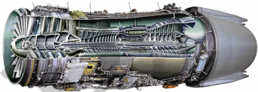
图 1 中等涵道比涡扇发动机
